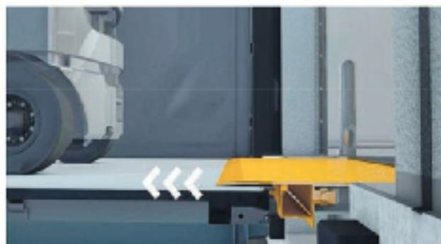
des niveleurs qui font la jonction peuvent parfois perdre leur appui sur la remorque, en raison de l'avancée progressive du camion due aux mouvements du chariot élévateur et de la compression des suspensions de la
